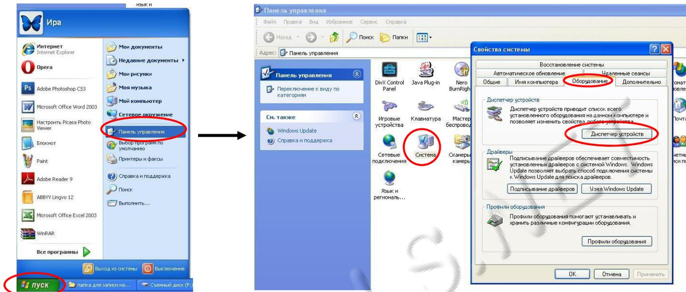
Далее выберите порт USB Serial Port, нажмите вкладку «Параметры порта», кнопку «Дополнительно», щелкните по вкладке «Номер COM-порта» и выберите COM3, или COM4, или COM5
